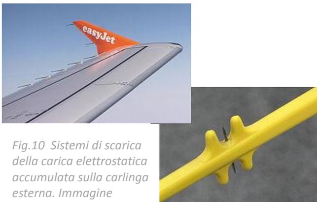
Fig.10 Sistemi di scarica della carica elettrostatica accumulata sulla carlinga esterna. Immagine Wikipedia
