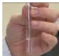
Quando si cominciano a vedere i primi segni di bollore (80-85°C circa) si aggiungono tutti in una volta 2mL della soluzione all'1% del citrato trisodico diidrato ( $\text{Na}_3\text{C}_6\text{H}_5\text{O}_7 \cdot 2\text{H}_2\text{O}$ ). Subito dopo si abbassa il termostato a circa 100°C in modo da ridurre la perdita di volume per evaporazione.
