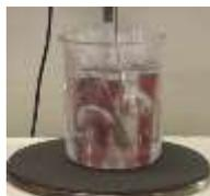
Se non possedete un agitatore magnetico potete distribuire la soluzione d'oro in più provette: dai 2 ai 3 mL di soluzione per ogni provetta (una parte evapora durante il processo di sintesi). Ponete poi le provette in un becker colmo a metà di acqua e di dimensioni tali da permettere alle provette di essere immerse almeno fino al livello raggiunto dalla soluzione.
