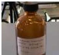
Con una pipetta graduata aspirate 2 mL della soluzione concentrata e versateli in una bottiglia scura (circa 300 mL di capienza). Con un cilindro graduato misurate e 98 ml di acqua distillata e versateli nella bottiglia (meglio ancora: aggiungete ai 2ml di soluzione acqua distillata in un matraccio fino a raggiungere i 100 ml). Tappate, agitate ed avvolgete in carta d'alluminio.
