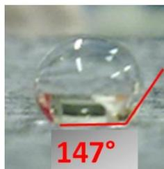
Stampate le foto o inseritele in un documento elettronico. Disegnate le due tangenti all'interfaccia liquido-solido e liquido-gas, rispettivamente, e misurate l'angolo di contatto così ottenuto col goniometro o per via trigonometrica. Stilare una classifica delle varie superfici, dalla meno idrorepellente a quelle superidrofobiche, utilizzando la tabella riportata nella scheda studenti.
