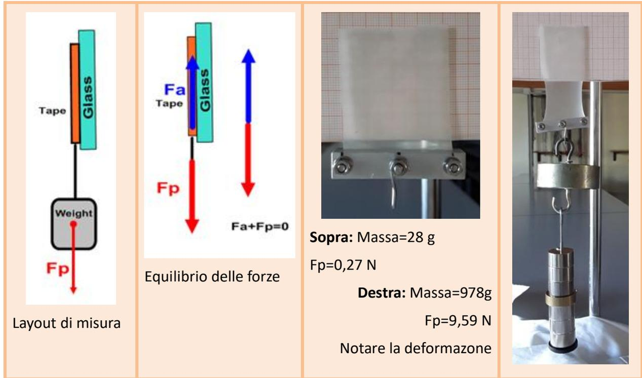
Figura 16 Condizioni sperimentali e campione di gecko prima e dopo l'applicazione del carico
