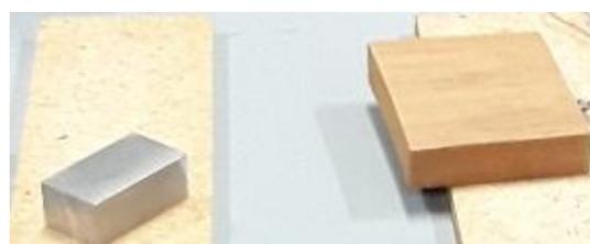
Figura 4 Adesione di oggetti su Gecko tape® ( a sinistra) ed esempio di altri oggetti utilizzati per le prove di adesione verticale ed orizzontale (sopra) .
