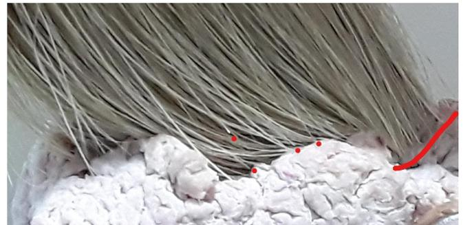
Figura 30 pennello a contatto con le rugosità di superficie, osservazione di come cambia il numero di punti di contatto in funzione dell'inclinazione del pennello rispetto alla superficie e della pressione che si esercita nella direzione perpendicolare al piano.
