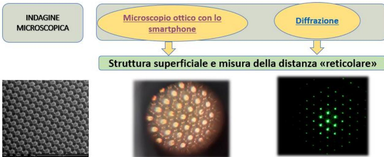
Figura 1 immagini del gecko tape con il microscopio elettronico ( a sinistra) con il microscopio ottico giocattolo ( al centro) e figura di diffrazione ( a destra)
