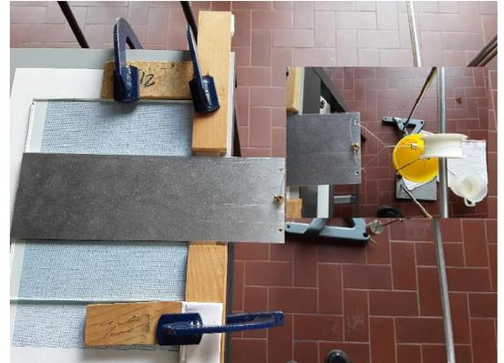
Figura 28 Riferimenti ed allineamenti-sopra carta millimetrata vetro e campione; sotto allineamento della slitta in alluminio
