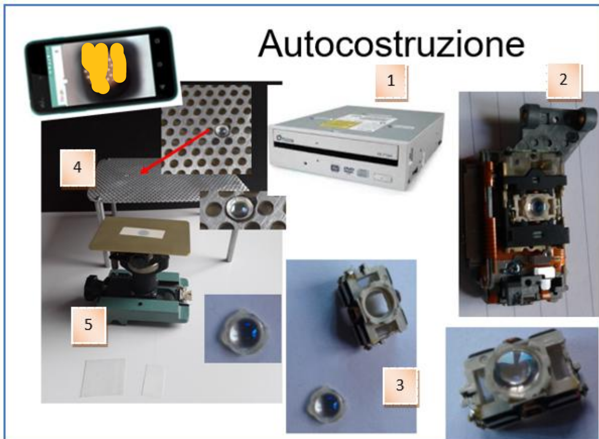
Figura 1 Materiali e fasi di costruzione del microscopio: dal DVD reader (1) al blocco lente (2); estrazione della lente (3) e suo fissaggio su un supporto (4); sistema di messa a fuoco (5). Il Sistema di illuminazione può essere realizzato con un LED ad alta intensità alimentato con una batteria da cellulare o con una mini torcia a LED.
