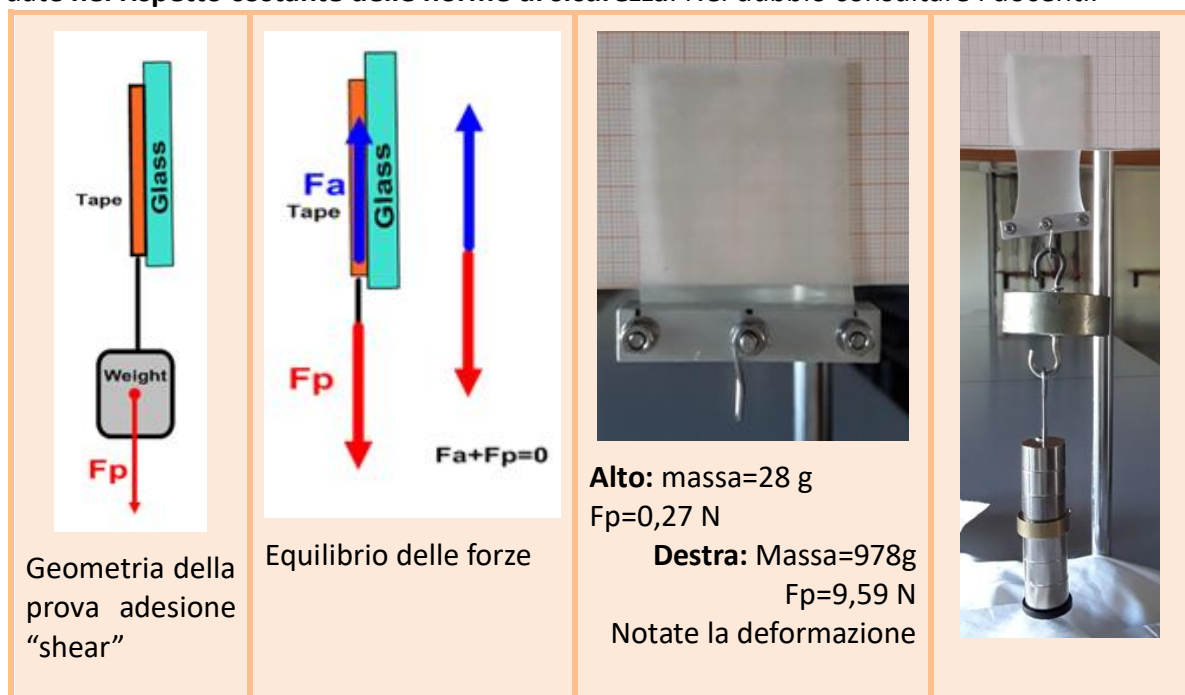
Figura 2 Layout di misura. Condizioni sperimentali e campione di gecko prima e dopo l'applicazione del carico
