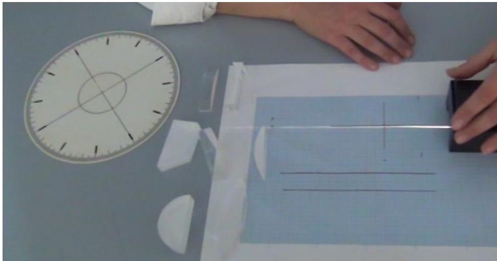
Figura 1 Ottica geometrica- kit di lavoro della Leybold con la sorgente ad un raggio (schermo con una fenditura )
